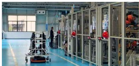
在青山工业DCT自动变速箱生产数字化车间,AGV小车正在运输物料。
