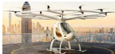
图2 Volocopter旗下18旋翼结构eVTOL (来源: Volocopter 官网)
