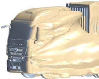
图4 整车总压为零等值面图
