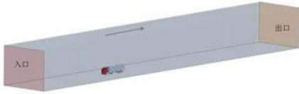
图3 整车外流场分析计算域示意图
