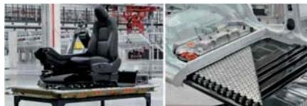
特斯拉CTC方案带来了空间利用率、轻量化、生产效率、车身扭转刚度以及降低供应商依赖度等优势。但另一方面,特斯拉CTC方案存在维修便利性差、无法实现换电路线兼顾等缺点。
