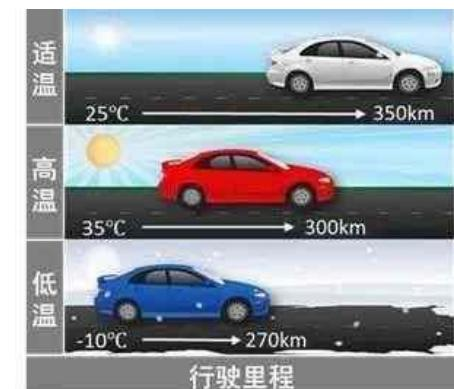
我们以常见的锂离子电池为例：锂离子电池工作原理本质上是内部正负极与电解液之间的氧化还原反应，在低温下电极表面活性物质嵌锂反应速率减慢、活性物质内部锂离子浓度降低，这将引起电池平衡电势降低、内阻增大、放电容量减少，极端低温情况下会出现电解液冻结、电池无法放电等现象，极大的影响电池系统低温性能，造成电动汽车动力输出性能衰减和续航里程减少。
