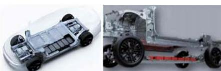
零跑CTC方案保留了原车身地板，并在下面设置以腔体，将没有上盖的电池包装进来，形成密封结构。
