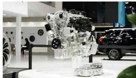
赛力斯汽车3.0增程器采用15:1超高压缩比、深度米勒循环、高滚流比、低压冷却EGR等技术，热效率超41%；扁线油冷发电机基于发动机匹配开发，高效区重合度在95%以上，系统最高油电转换率达3.44 kWh/L；与高速油冷永磁同步电机和155Wh/kg的CTP技术电池相结合，动力性与燃油经济性均表现出色。
