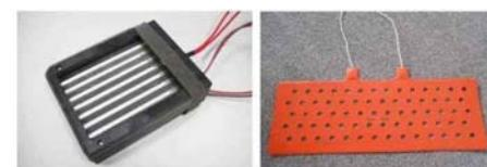
PTC由于使用安全、热转换效率高、升温迅速、无明火、自动恒温等特点而被广泛使用。其成本较低，对于目前价格较高的动力电池来说，是一个有利的因素。但是PTC的加热件体积较大，会占据电池系统内部较大的空间。绝缘柔性电加热膜是另一种加热器，它可以根据工作的任意形状弯曲，确保与工件紧密接触，保证最大的热能传递。硅胶加热膜是具有柔性的薄形面发热体，但其需与被加热物体完全密切接触，其安全性要比PTC差些。液体循环加热液冷的电池包在当前的设计中，因为其加热效果好，散热分布均匀，安全可靠等特点，占据了主流的位置。在电池包内结构上，通常是会设计利于散热的水道，将热量均匀的散发到电池包内部，达到电池温度的均匀上升。
