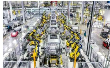
以智能制造为依托，融合全过程质量自动化，目前赛力斯汽车已搭建了质量数字化平台和管理体系。实现抓取每一台车生产过程中的510种工艺设备、23类过程参数、3822项过程质量记录的9万多项特性数据，形成一车一档，实现精准追溯，为全面实施过程能力监控提供了大数据支撑，与合作伙伴联合品控，坚持“一车一体检”，为每辆车生成一份“体检报告”，只有100%合格才能出厂。
