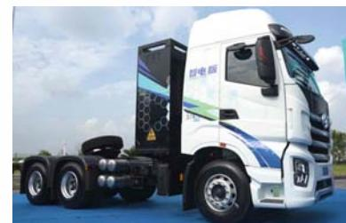
高效补能为用户实现高效运营，车辆最大电量电池可达430kWh，最大续航超400km，领先行业同类产品；其中充换一体的补给方式为用户补能带来便利，车辆可在3-5分钟完成换电，40分钟完成双枪充电，为运输节约更多宝贵时间；同时车辆率先采用高速水冷扁线电
